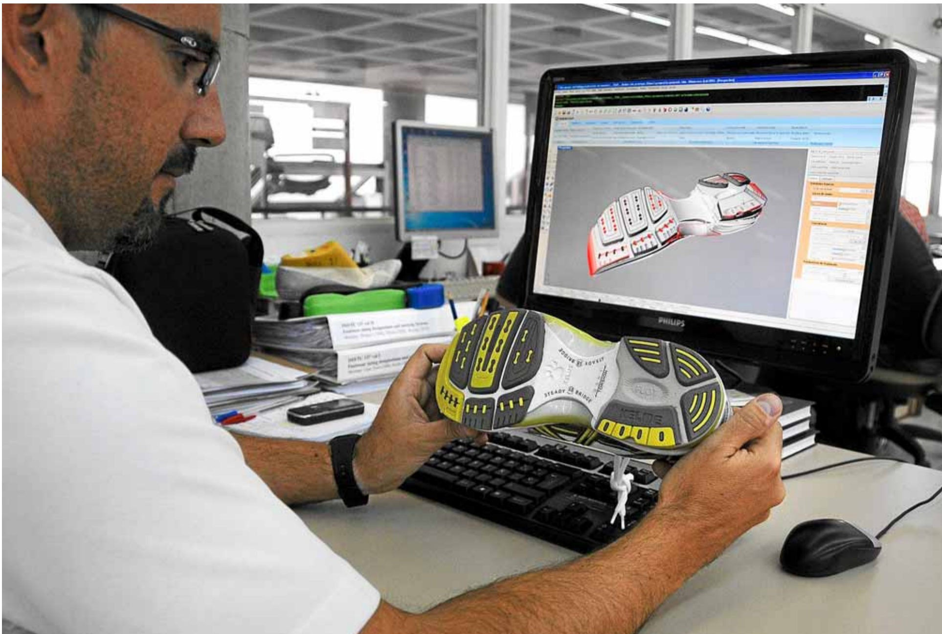
Un técnico compara el diseño de la suela del modelo GravityMC con el del ordenador en la sede de Inescop en Elda. / CRISTÓBAL LUCAS
