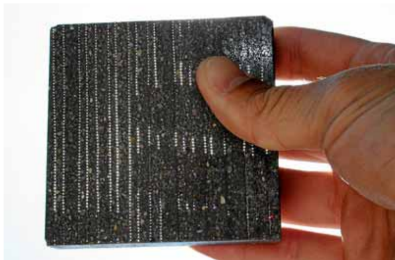
El hormigón traslúcido desarrollado por Aidima para Materializa. / E. M.
